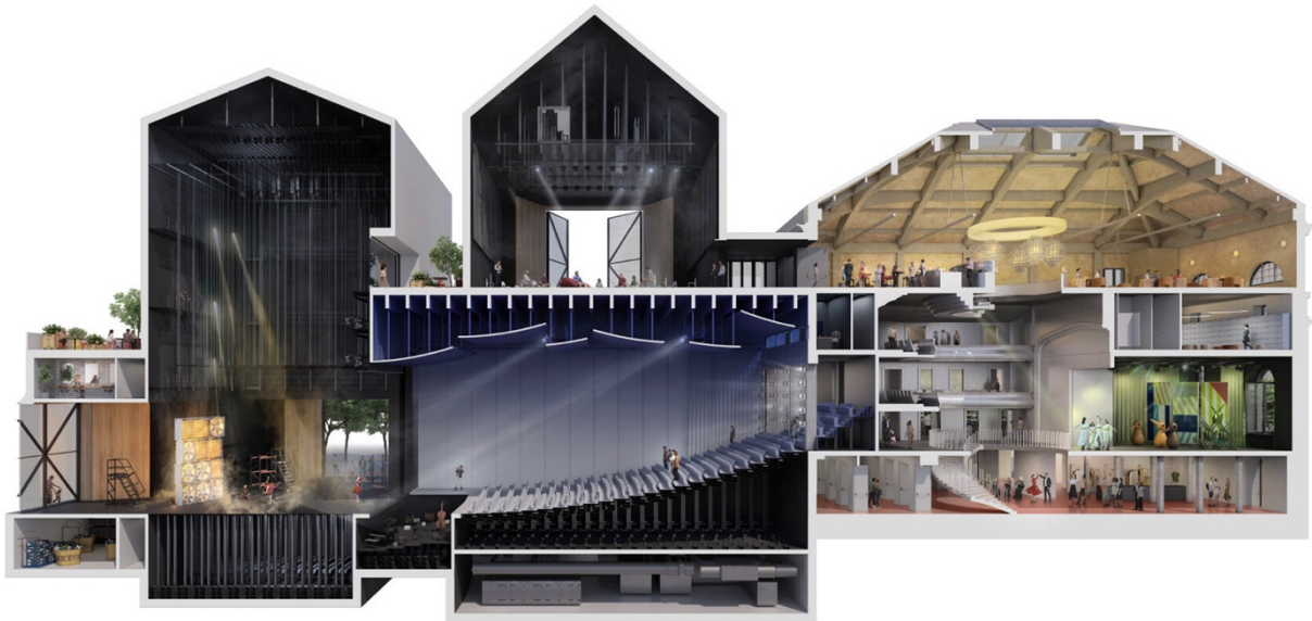
Schnittperspektive des Siegerprojektes mit Bühnenturm, drei Sälen und mehrgeschossigem Foyer im alten Theater
