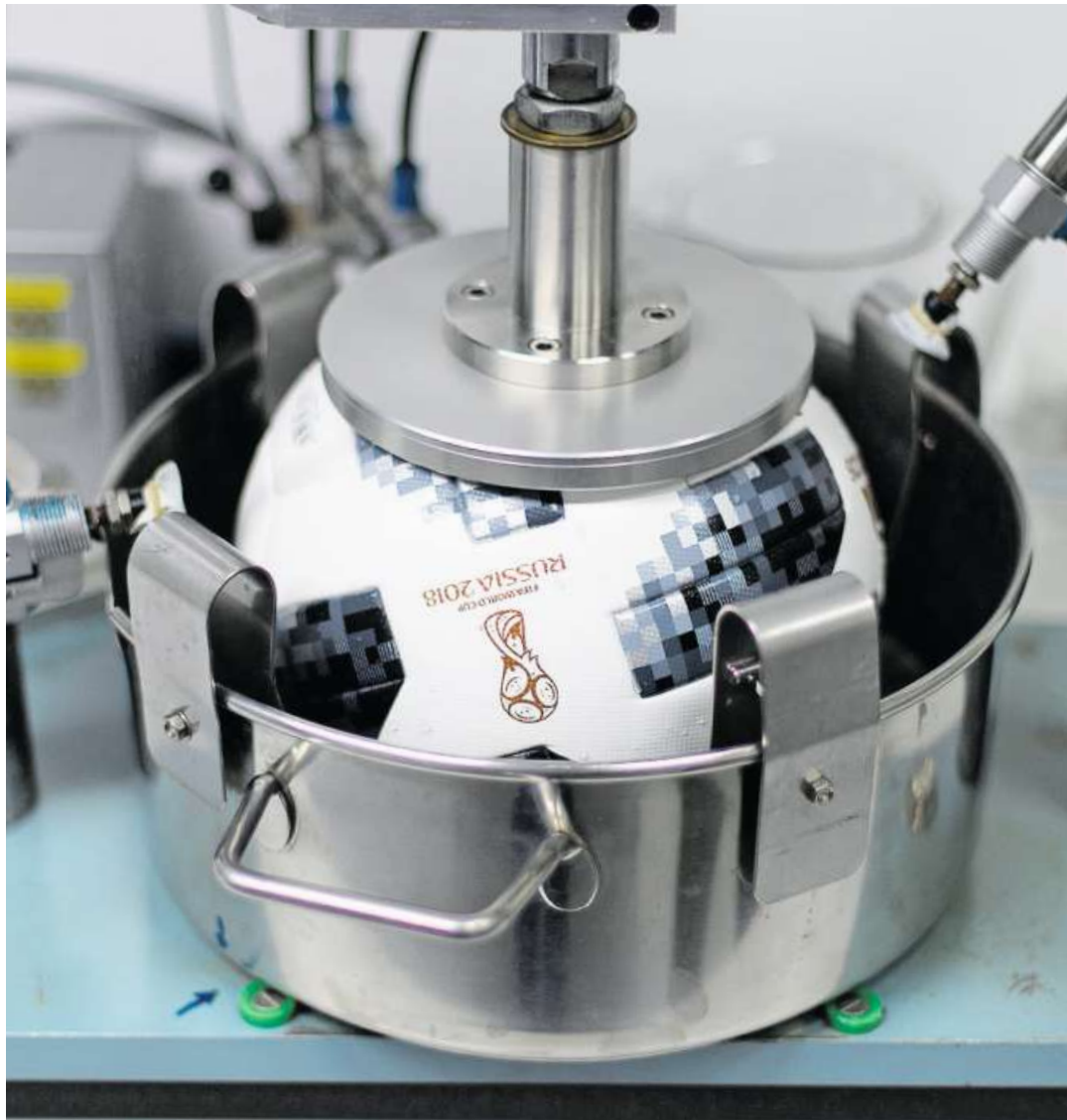
Im Wassertest wird die Dichtigkeit des WM-Balls Telstar 18 geprüft.
